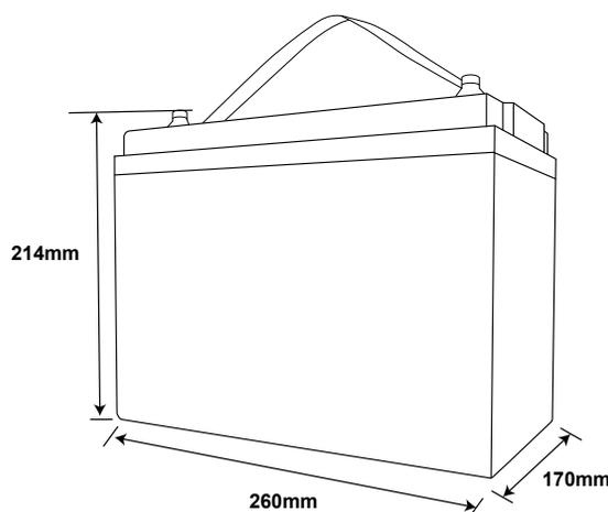
Dimensioni con terminali L260mm\*W170mm\*H214mm
