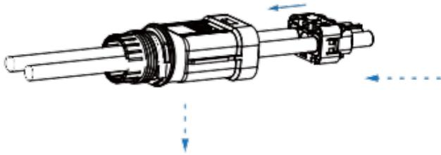
6 Inserire il connettore della batteria nell'inverter; quando il collegamento della batteria è corretto si sentirà un clic.
