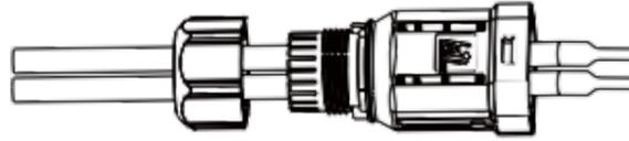
3 Inserire il cablaggio nei terminali secondo le polarità "+" e "-", posizionare i terminali isolati paralleli ai terminali; la coppia della vite di crimpatura è 2,0±0,1 N.m
